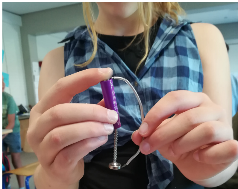
Batterimaget – et batteri, en skrue og en stump ledning.
